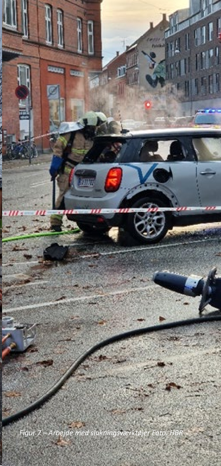
Figur 8 – Læsning af elbil med kraftig afgasning fra batteriet. Foto: BEROS
