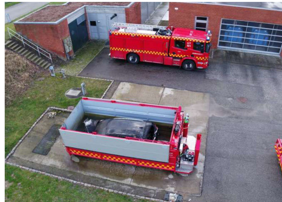
Figur 15. Brandslukningscontaineren indeholdende bil på spildevands- og rensningsanlægget (Mølleåværket A/S). Dette giver sikker mulighed for udledning af slukningsvand.
